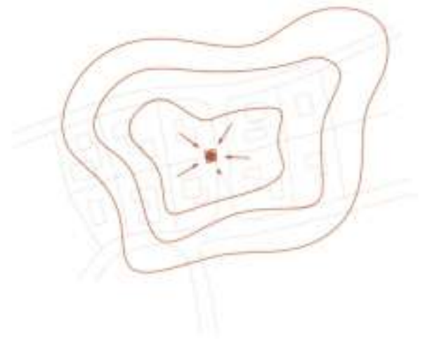
Figura 2.27. Un ejemplo de cómo un punto de captación puede dar servicio a varias viviendas cubriendo una gran superficie de succión. Estos cálculos pueden realizarse con programas de análisis de fluidos
