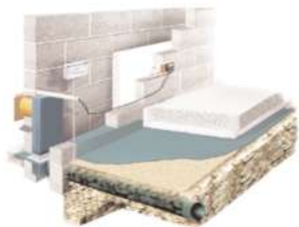
Figura 2.25. Sistema de captación que basa su funcionamiento en una serie de tubos perforados y enterrados bajo la vivienda, similares a los usados como tuberías de drenaje, que se conectan a un extractor. Rad Safe Supplies Ltd.
